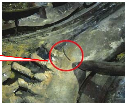
補修後の磨き作業で グラインダーが接触した
